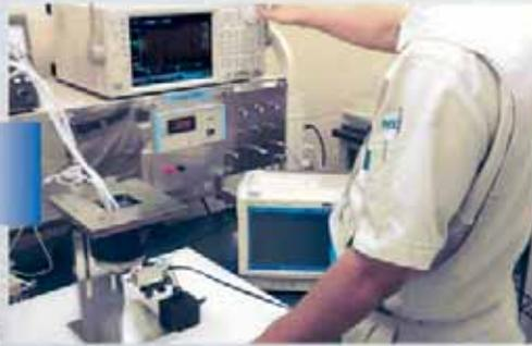
Mesure et analyse des vibrations par FFT.
