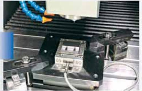
Mesure des efforts de coupe par dynamomètre.
